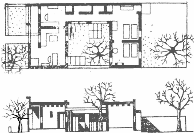
Рисунок 1. Типичное проектное решение индивидуального жилого дома с внешними и внутренними дворами для климатических условий региона Ближнего Востока (план и разрез).
